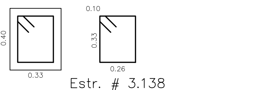
SECCIÓN 6-6 - VIGAS AEREAS - ESC. 1:15
